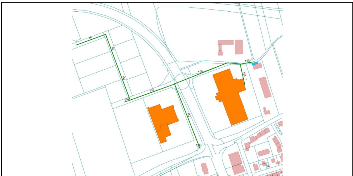
Abbildung 2: Bestehende Fernwärmekunden im Gewerbegebiet, bestehendes Netz
